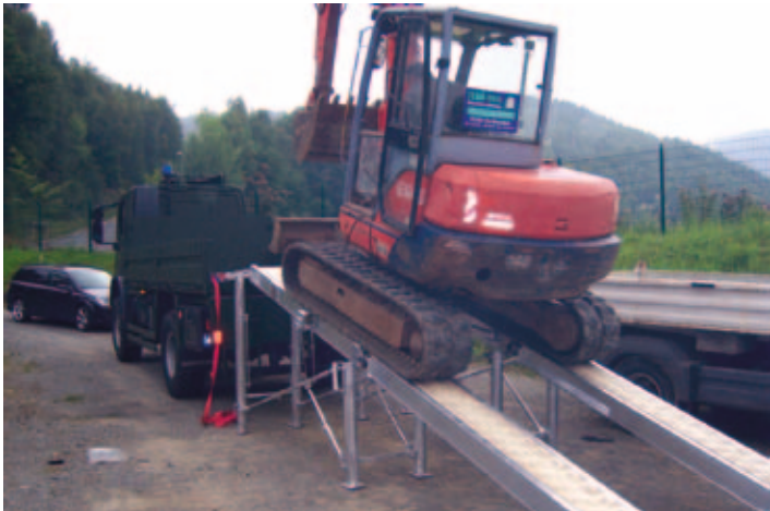
6) Mobil lastestasjon 5) Sammenleggbare AVS-rampe for anleggsmaskiner med tre hjul
